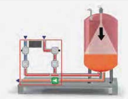
Из-за условий эксплуатации вода в установке начинает остывать и сжиматься, а ее давление падает. Вода, хранящаяся в расширительном баке, снова надувается в установку при включении насоса, установка нагнетается до желаемого давления, а давление в установке поддерживается постоянным. Когда давление в установке достигает нужного давления, насос отключается.
