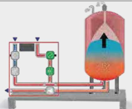
По мере повышения температуры воды в установке вода начинает расширяться и давление повышается. Система автоматизации расширения насосом оценивает информацию и обеспечивает открытие моторизованного клапана и перекачку расширяющейся воды в установке в бак. Таким образом, давление установки поддерживается постоянным.
