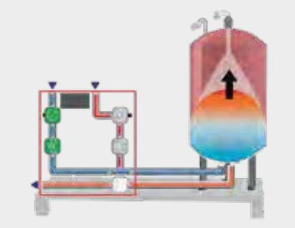
В зависимости от условий использования может быть уменьшение воды в установке. Система автоматизации потока данных, интегрированная в насосную систему расширения / повышения давления, и расходомер измеряют количество воды и автоматически подают воду в установку из магистралей. Давление в установке поддерживается постоянным за счет автоматического пополнения водой. (Доступно только в версии TPG-PRO.)
