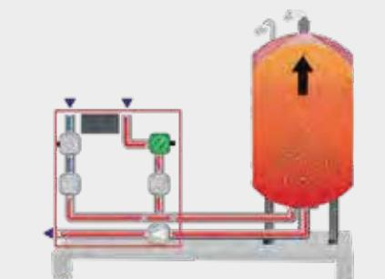
Когда температура воды в системе выходит на режим, давление в системе поддерживается постоянным благодаря регулированию давления насосной системы расширения/наддува до достижения максимальной нагрузки.
